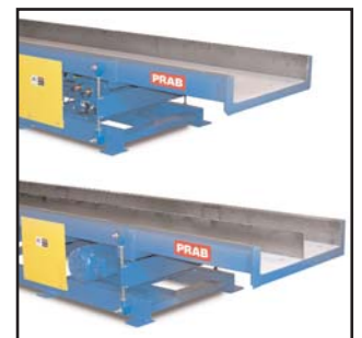
Napęd zlokalizowany poniżej z niewymagającymi obsługą słupkami.
